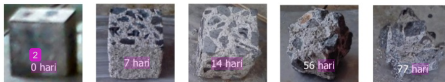
Gambar 4. Kondisi visual beton N30 setelah direndam asam sulfat ( H_2SO_4 ) 2%
