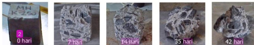
Gambar 3. Kondisi visual beton N20 setelah direndam asam sulfat ( H_2SO_4 ) 5%
